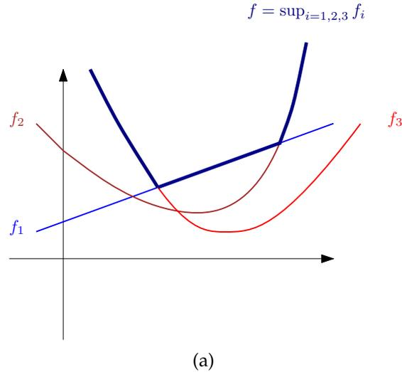
FIG. 4 : Convexité de la fonction sup de trois fonctions  $f_1, f_2, f_3$ .
